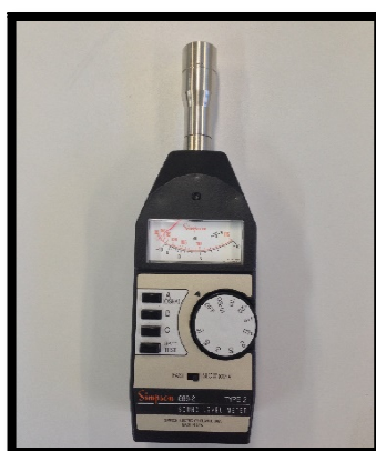
Figura 9 - Decibelímetro Simpson, 886-2. (Fonte: Acervo Particular)
